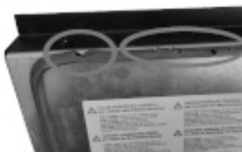
Fig. 27 - Junta deteriorada
