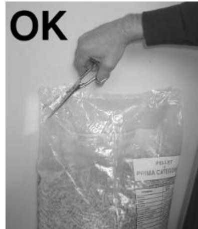
Fig. 19 - Abertura correcta del saco del pellets
